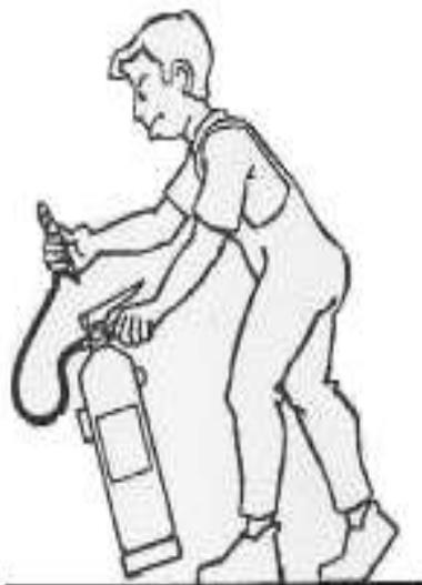
3. Presionar la palanca de la cabeza del extintor y en el caso de que exista apretar la palanca de la boquilla realizando una pequeña descarga de comprobación.
