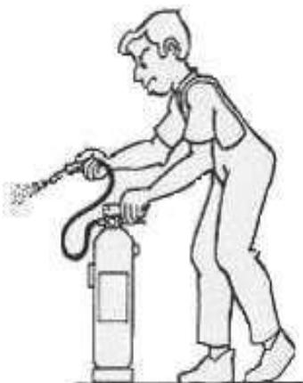
4. Dirigir el chorro a la base de las llamas con movimiento de barrido. En caso de incendio de líquido proyectar superficialmente el agente extintor efectuando un barrido evitando que la propia presión de impulsión provoque derrame del líquido incendiado. Aproximarse lentamente al fuego hasta un máximo aproximado de un metro.
