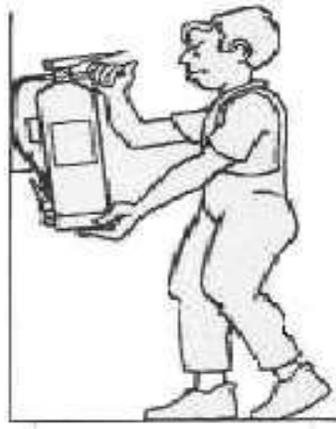
2. Tomar la boquilla de la manguera del exterior y comprobar, en caso que exista, que la válvula o disco de seguridad ( V ) esta en posición sin riesgo para el usuario. Sacar el pasador de seguridad tirando de su anillo.
