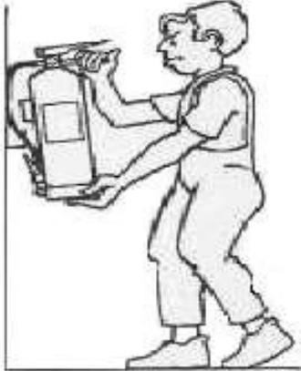
2. Tomar la boquilla de la manguera del exterior y comprobar, en caso que exista, que la válvula o disco de seguridad ( V ) esta en posición sin riesgo para el usuario. Sacar el pasador de seguridad tirando de su anillo.
